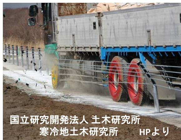
大型トラックによる衝突実験の様子
