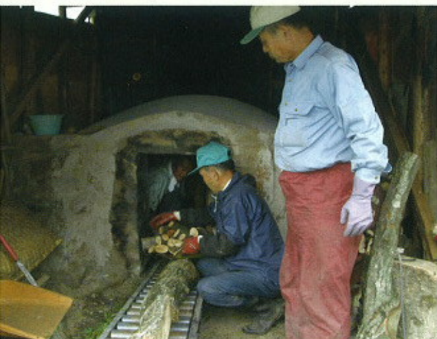
初めての炭出しが終わり、2回目の火入れを行う赤川さんや森田さんら。何回かこの作業を繰り返し、窯を乾燥させていきます。
