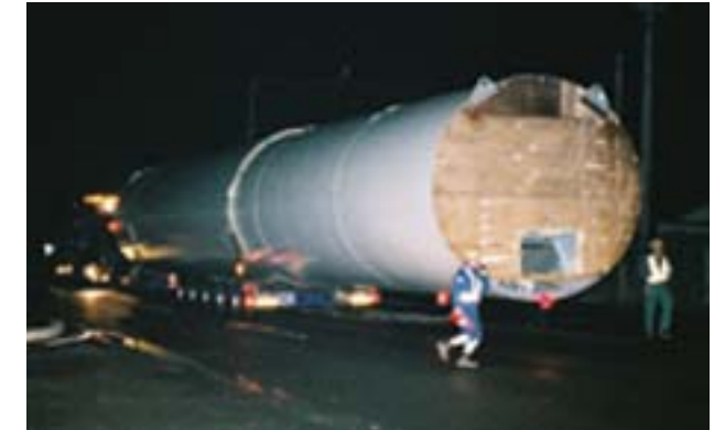
風車の支柱の直径は最大4.3メートル。傍らに立つ警備員との対比をご覧ください
