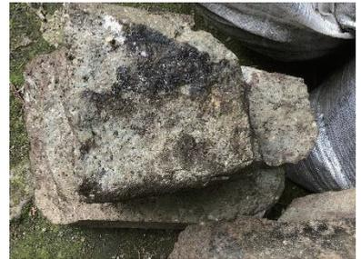
写真16 裏込栗石の被熱痕
